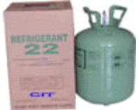
R22(Freon22, 二氟一氯甲烷 Chlorodifluoromethane), 分子式  $\text{CHClF}_2$ , 分子量 86.47。R-22 在常温下为无色, 近似无味的气体, 不燃烧、无腐蚀、毒性极微, 加压可液化为无色透明的液体, 为 HCFC 型制冷剂。R-22 的化学稳定性和热稳定性均很高, 特别是在没有水份存在的情况下, 在 200°C 以下与一般金属不起反应。在水存在时, 仅与碱缓慢起作用。但在高温下会发生裂解。R-22 是一种低温制冷剂, 可得到-80°C 的制冷温度。适用于家用空调、中央空调和其它商业制冷设备。也可用作聚四氟乙烯树脂的原料和灭火剂 1121 的中间体。
